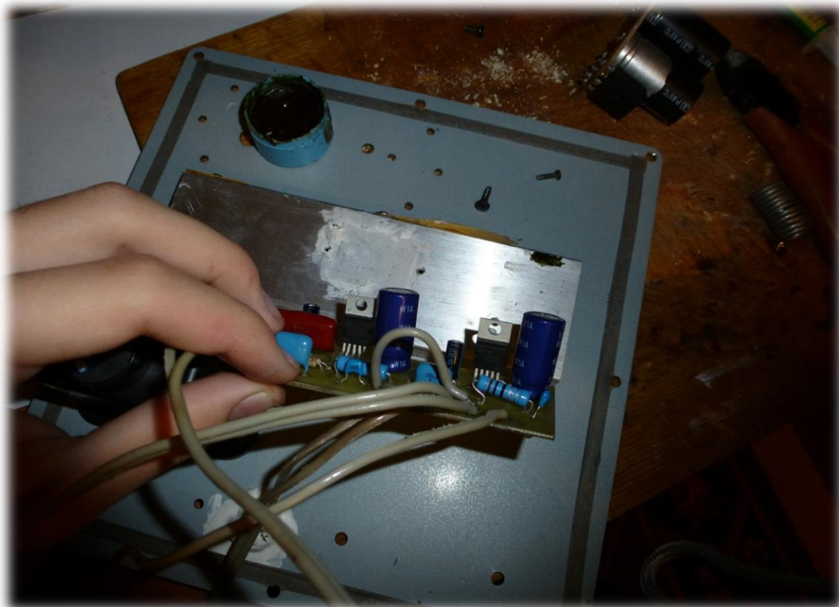
Установка платы усилителя на радиатор.
